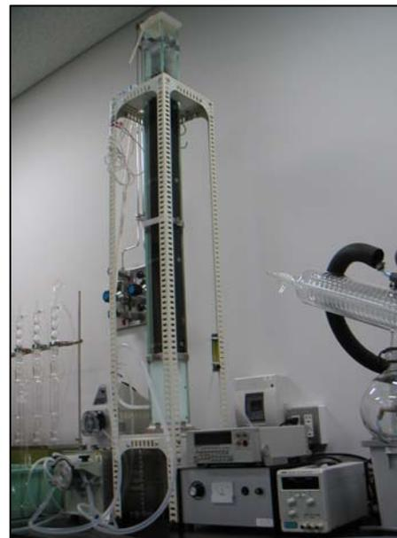
水中の難分解性有機物を分解除去するためのオゾン電解反応試験
